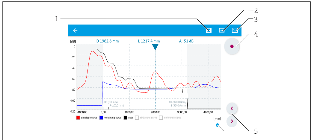
图 26 实例：Android 设备使用 SmartBlue 显示包络线
